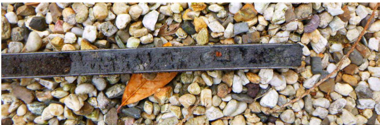
Figuur 20: Foto van de top van het met sloopresten van mortel en baksteen vermengde kleipakket dat op alle boorpunten onder het opgebrachte zand is aangetroffen.
