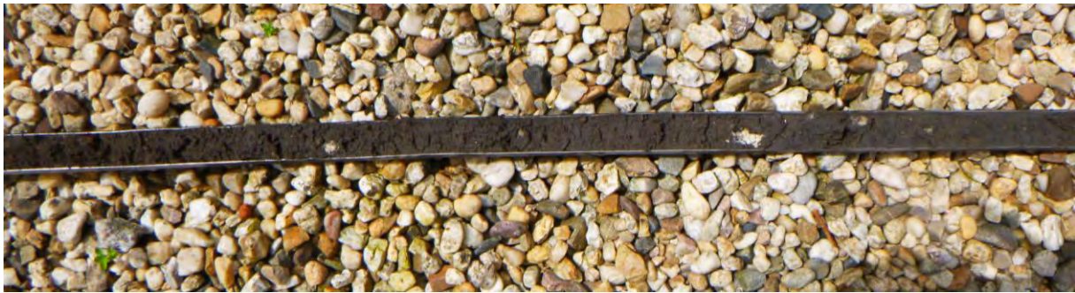
Figuur 21: Het venige en met sloopresten vermengde kleipakket dat op boorpunt 2 is aangetroffen.
