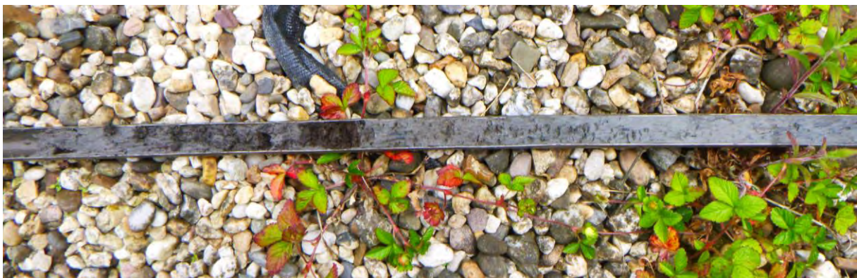
Figuur 22: Het laagje matig tot sterk veraard veen (links van het midden) dat in boring 2 is aangetroffen met links daarvan een rommelig pakket van met veenbrokken vermengde klei en rechts, zwak venige klei.
