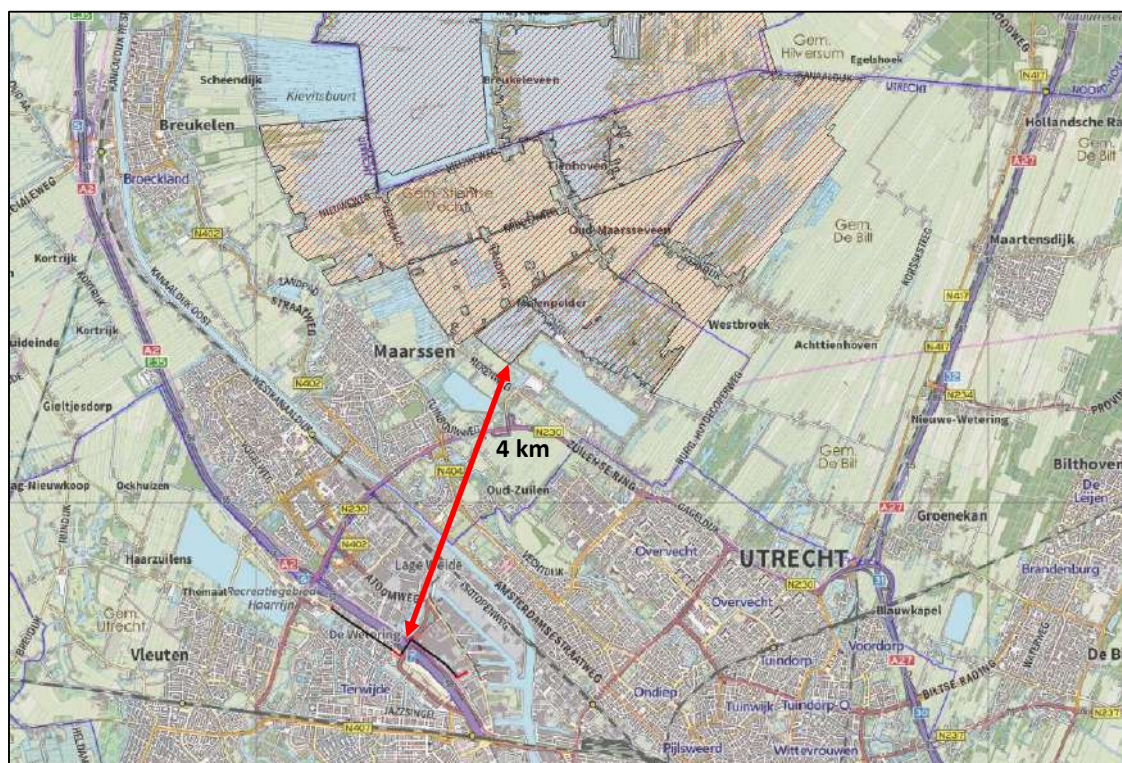
Figuur 2.4: Ligging van Natura 2000- en Vogelrichtlijngebied Oostelijke Vechtplassen ten opzichte van het tracé met in zwart HDD's en in rood open ontgraving. Bron achtergrond: opentopo.
