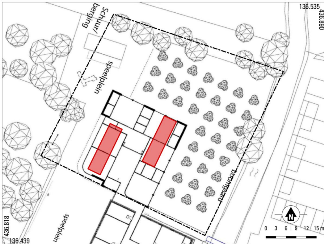
Fig. 1.2. Schoonrewoerd-Kerkweg 3a. Het puttenplan geprojecteerd op de ontwerpschets van de uitbreiding van de school (bron: gemeente Vijfheerenlanden). Stippellijn: plangebied. Rood: proefsleuven. Schaal 1:600.
