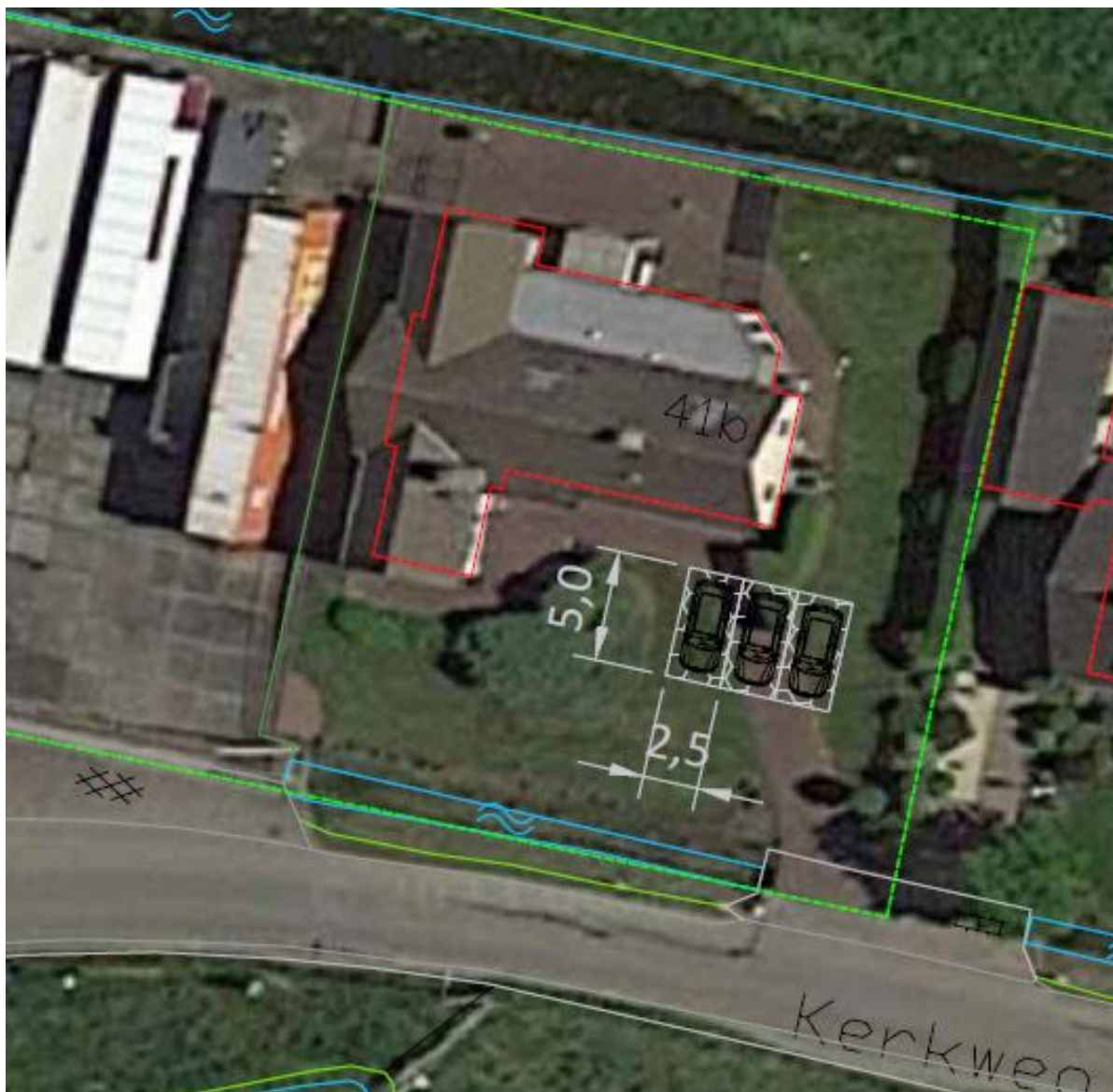
Afbeelding 7: Voorbeeld oplossen parkeerbehoefte op eigen terrein
