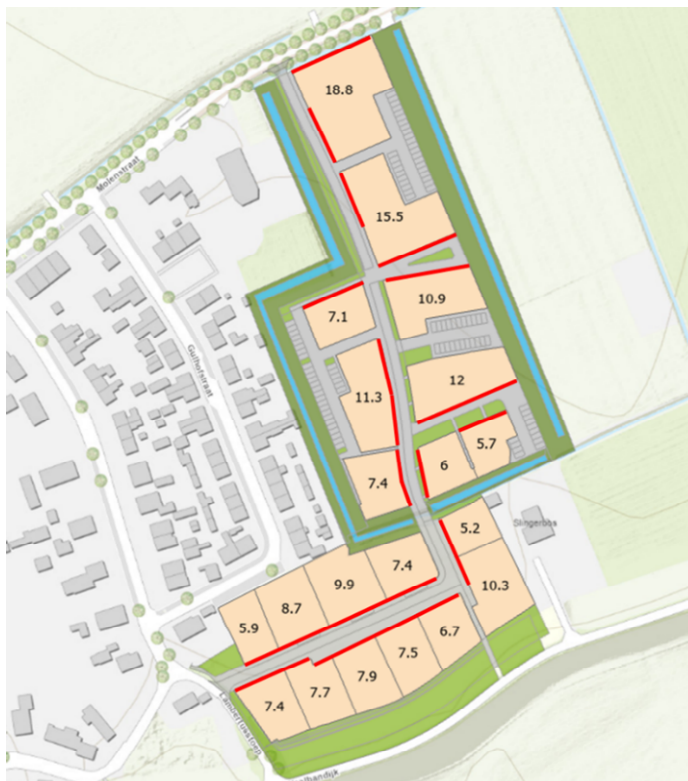
Figuur 6-2: Minimale bergende capaciteit van de particuliere infiltratievoorzieningen op basis van het definitieve verkavelingsplan, met de zijde van het perceel waar overtollig hemelwater bovengronds dient te worden aangeboden (rode lijn)
