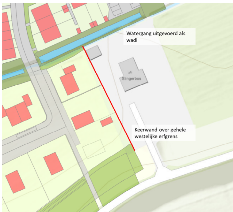
Figuur 6-23: Situatieschets keerwand Waalbandijk 45
