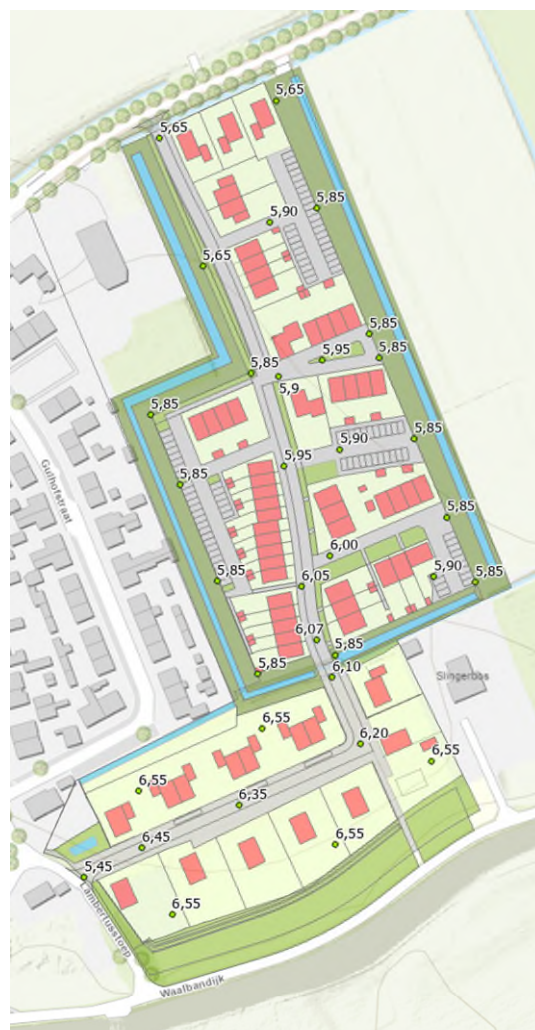
Figuur 6-5: Indicatieve maaiveldhoogten benodigd voor beoogde afvoerstructuur
