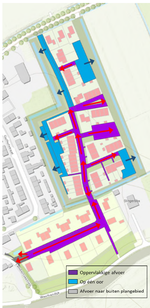
Figuur 6-4: afvoerroute oppervlakkige afvoer
