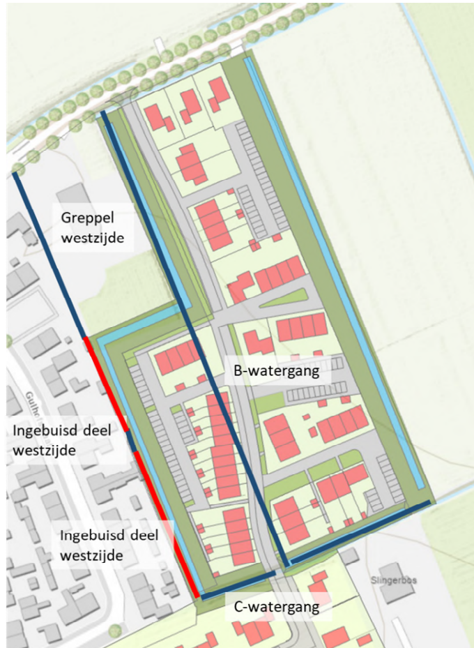
Figuur 6-19: Belangrijke structuren voor de huidige ontwatering/afwatering
