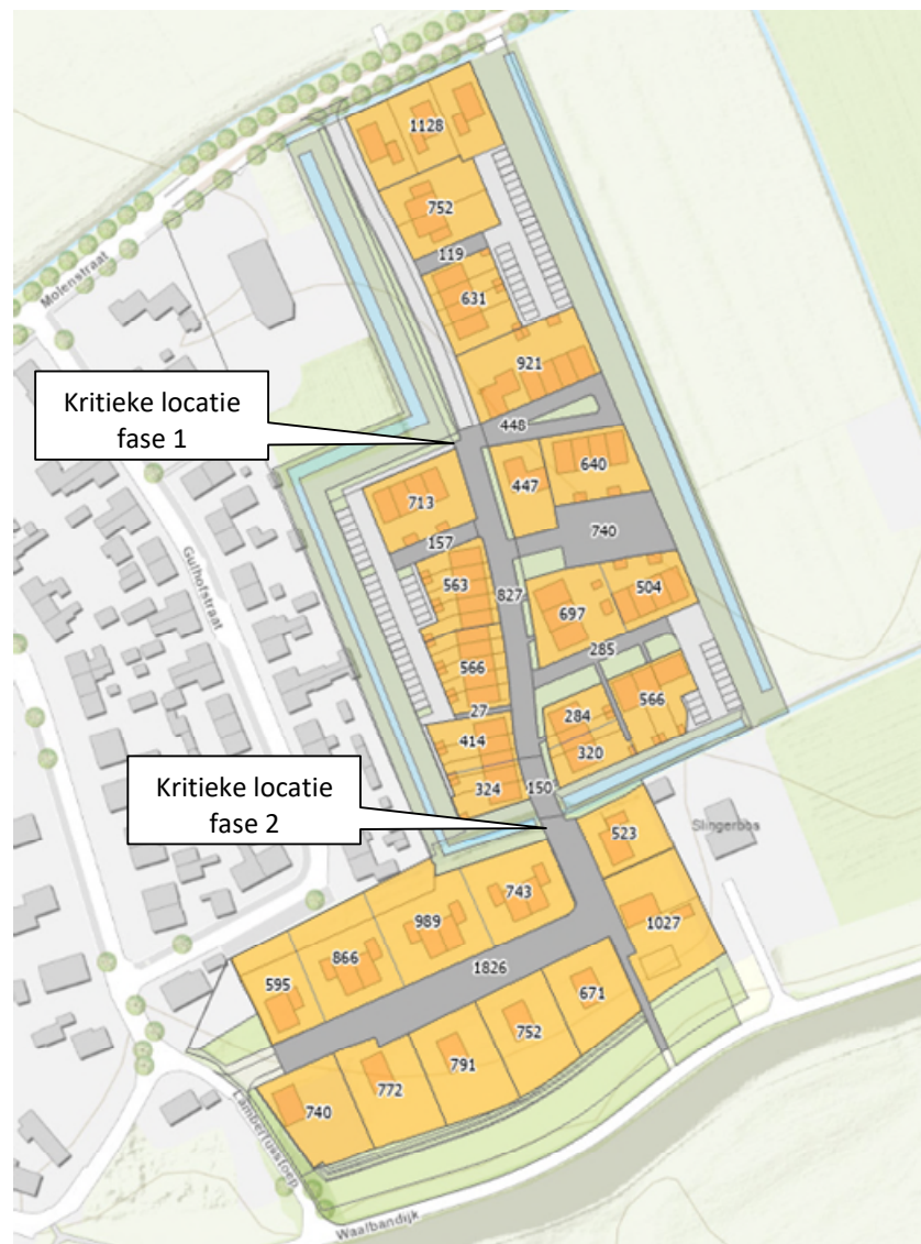
Figuur 6-7: kritieke locaties afvoercapaciteit wegprofiel (fase 1 en 2 separaat)
