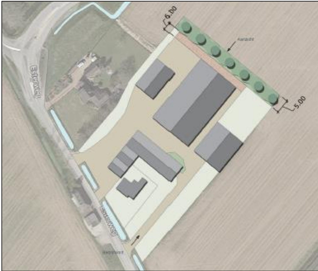
Figuur 2.10: Schematische impressie van de plaatsing van de beoogde opslagloods met landschappelijke inpassing.
