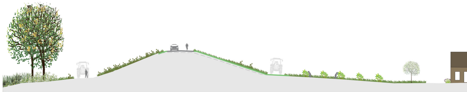
Profiel TG046 Lichte binnenwaartse asverschuiving, buitendijkse beheerstrook, binnendijkse beheerstrook in dubbelgebruik met agrariër, schaal 1:500
