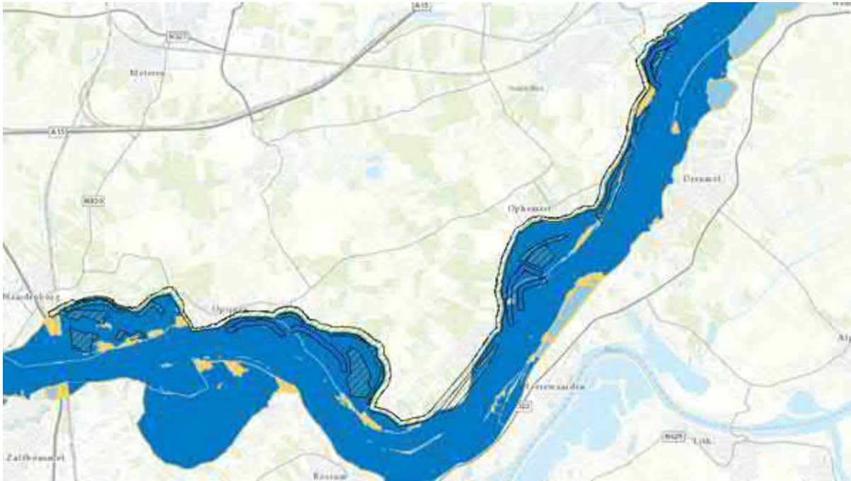
Figuur 5-7 Uitsnede KRW-Waterlichaam Bovenrijn-Waal, Q 5928 m³/s (1% overschrijding). De lichtblauwe en donkerblauwe delen zijn watervoerend, waarbij de donkerblauwe delen bij de vermelde afvoer zijn aangesloten op het waterlichaam. De afvoer die is weergegeven in deze figuur treedt gemiddeld minimaal 5 dagen per jaar op. De door dijkversterking beïnvloede ecotopen uit Figuur 5- staan derhalve minimaal 5 dagen per jaar in contact met de rivier en zijn daarom van belang voor de ecologische kwaliteit van het waterlichaam en het behalen van de KRW-doelen van het waterlichaam. Verlies aan ecotopen moet worden gecompenseerd.
