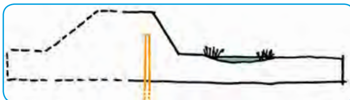
Behoud van buitendijkse waarden door toepassen constructie
