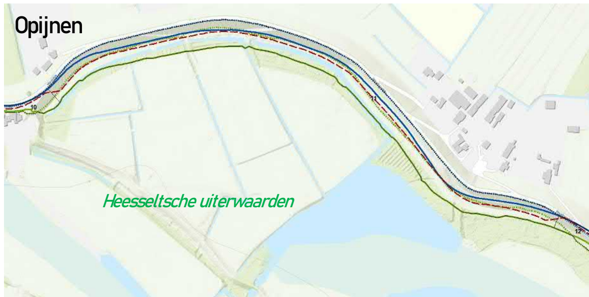
Figuur 4 Buitenwaartse dijkverlegging en versterking bij Opijnen (traject 11)
