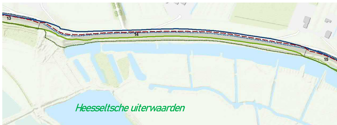
Figuur 5 Binnenwaartse kruinverplaatsing en dijkversterking tussen Opijnen en Heesselt (traject 14)
