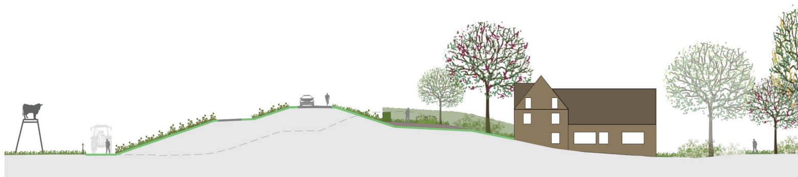
Profiel TG118+50 buitenwaartse asverschuiving ter hoogte van Waalbandijk 76, schaal 1: 500
