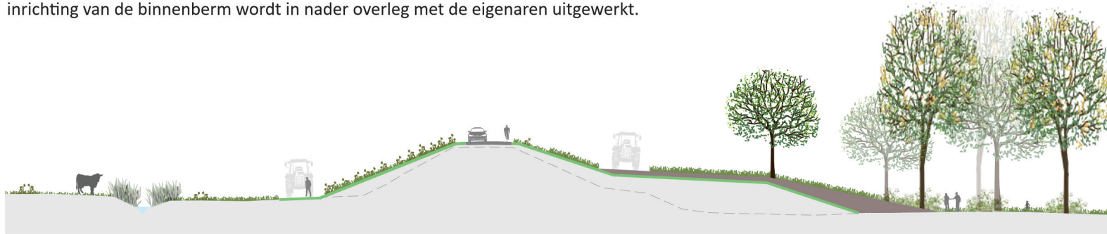
Profiel TG122 binnenwaartse versterking ter hoogte van de achtertuin van Kerklaan 17, schaal 1: 500
