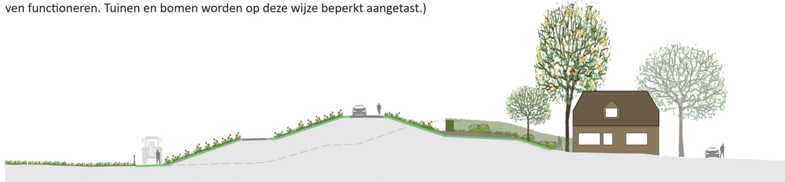
Profiel TG119 buitenwaartse asverschuiving ter hoogte van Kerklaan 3, schaal 1: 500
