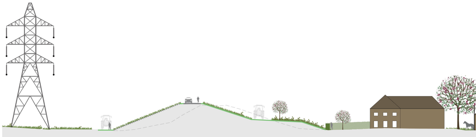
Profiel TG124+50 Binnenwaartse versterking met bloem en kruidenrijke binnenberm ter hoogte van Kerklaan 16, schaal 1: 500
