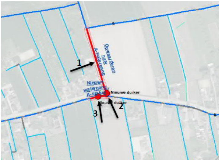
Figuur 9-40 Verbreding watergang bij Zandstraat
