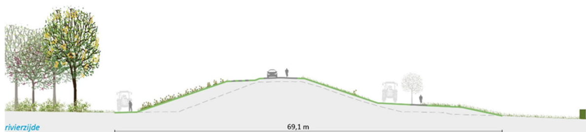
Figuur 6-13. Dwarsprofiel Dijkvak 7a
