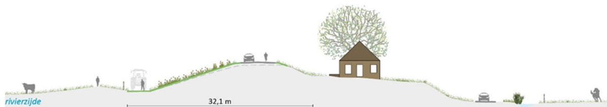
Figuur 6-14. Dwarsprofiel dijkvak 8a
