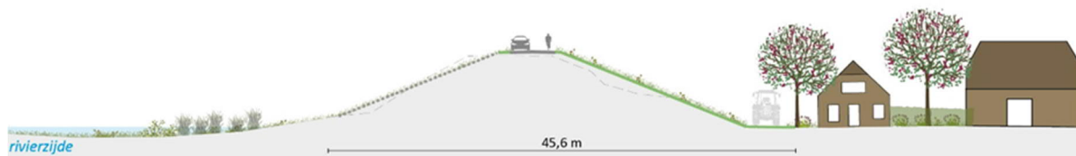
Figuur 6-50. Dwarsprofiel dijkvak 26
