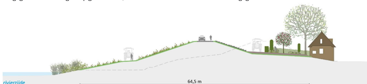
Figuur 6-66. Dwarsprofiel dijkvak 35a
