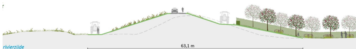
Figuur 6-60. Dwarsprofiel dijkvak 31a
