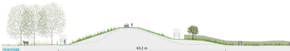
Figuur 6-6. Dwarsprofiel dijkvak 3
