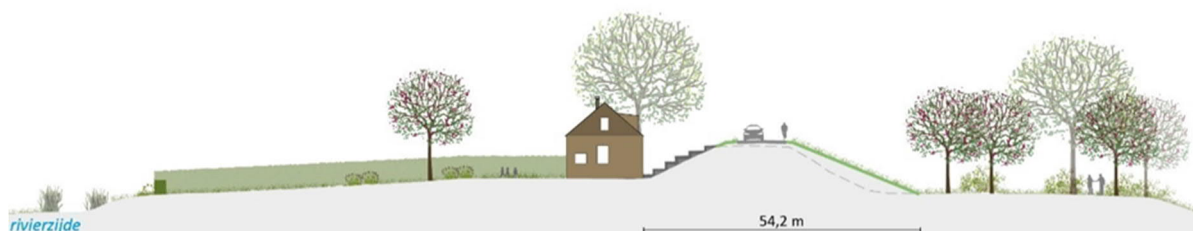
Figuur 6-42. Dwarsprofiel dijkvak 23b, bij monumentale arbeiderswoningen
