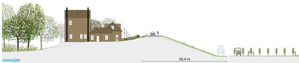
Figuur 6-55. Dwarsprofiel dijkvak 29a
