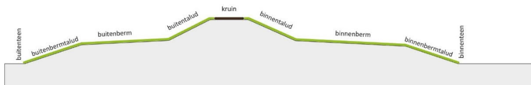
Figuur 2-2. Principe opbouw van de waterkering
