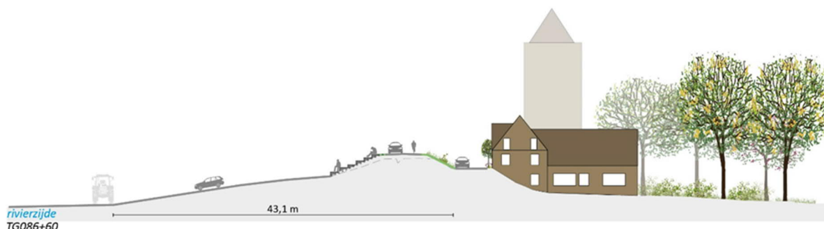
Figuur 6-31. Dwarsprofiel dijkvak 16c
