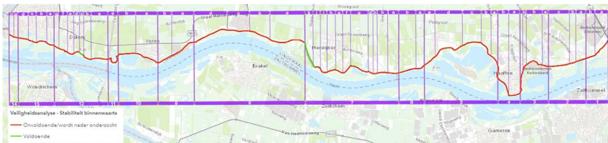
Figuur 2.8 Overzicht van status van de dijk o.b.v. faalmechanisme macrostabiliteit binnenwaarts
