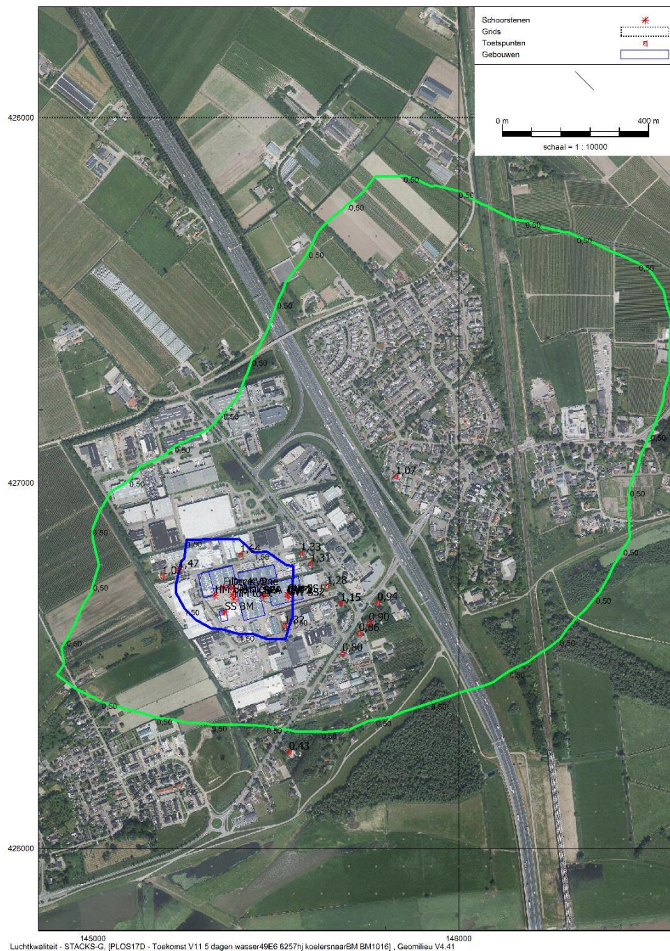
Figuur 4 Geurimmissie rond Plomp en Zn. berekend voor de aangevraagde situatie uitgaande van 7.144 emissie-uren per jaar, behalve voor de banddroger: 6.257 uur/jaar. Contouren van 0,5 (lichtgroen) ; 1,5 (blauw) en 5 (rood) \text{ou}_E/\text{m}^3 als 98-percentielwaarde.
