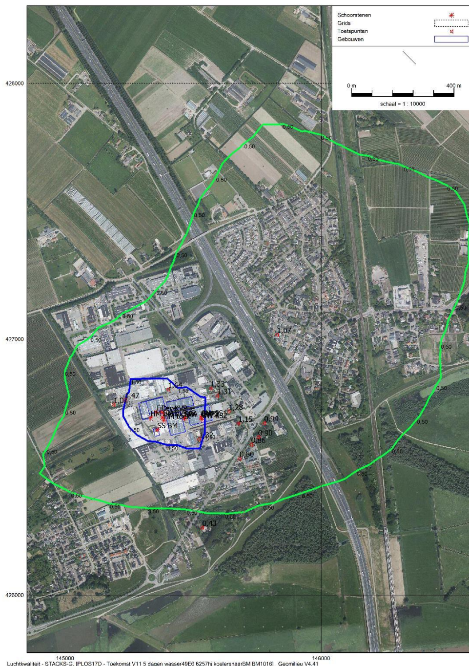
Figuur 4 Geurimmissie rond Plomp en Zn. berekend voor de aangevraagde situatie uitgaande van 7.144 emissie-uren per jaar, behalve voor de banddroger: 6.257 uur/jaar. Contouren van 0,5 (lichtgroen) ; 1,5 (blauw) en 5 (rood) ou_E/m^3 als 98-percentielwaarde.
