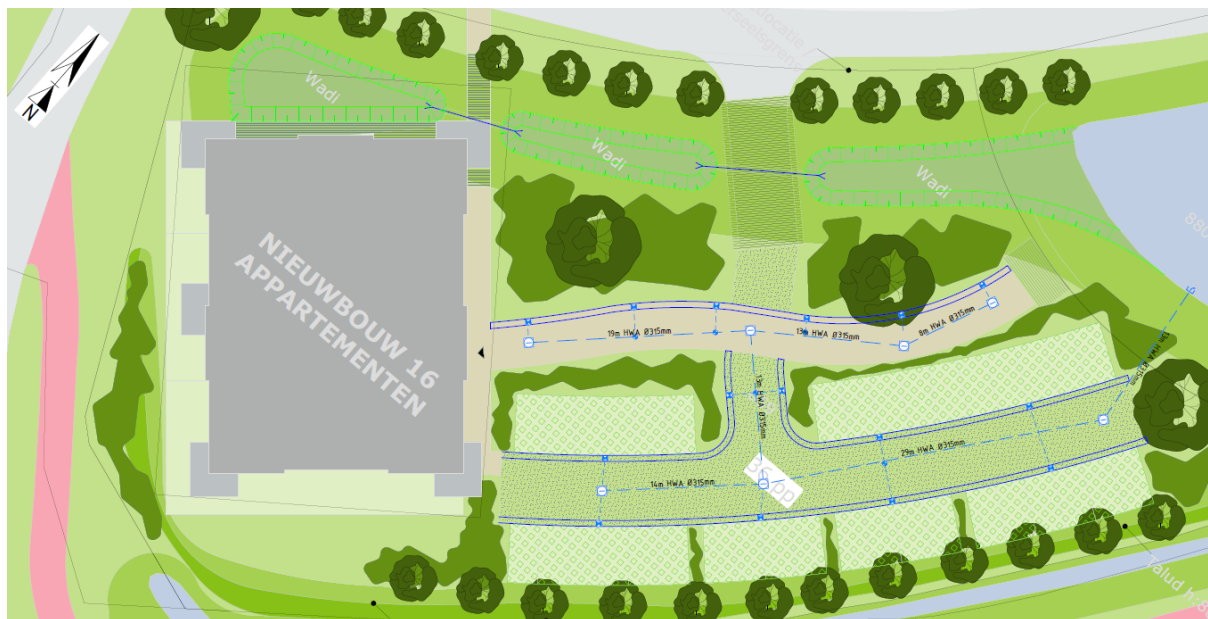
Grasbetonstenen zijn niet alleen een aantrekkelijke keuze voor verharding met een groene uitstraling, maar ze spelen ook een cruciale rol bij het beheer van regenwater. Deze betonnen stenen, die openingen bevatten voor grasgroei, bieden een manier om regenwater te infiltreren. Naast de grasbetonstenen zelf is de kwaliteit van de ondergrond essentieel voor effectieve regenwaterinfiltratie. Een goed doorlatende fundering is erg belangrijk. Daarbij fungeert de ondergrond als groeimedum voor de grasplanten die in de openingen van de grasbetonstenen groeien. Het moet dus gelijke tijd voedzaam en vruchtbaar zijn.
