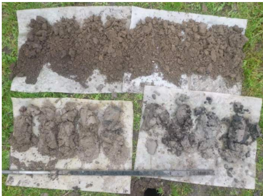
Figuur 2. Tuil – Haarstraat 8. Boring 2 met de bodemopbouw ter plaatse van de woning. Uitgelegd is tot 2.00 m -mv en in de guts is het deel zichtbaar tussen 2.00 tot 3.00 m -mv.
