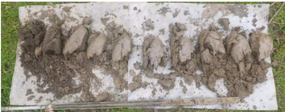
Figuur 4. Boring 10. Uitgelegd is tot 100 cm -mv en in de guts het deel tussen 100 en 140 cm -mv.
