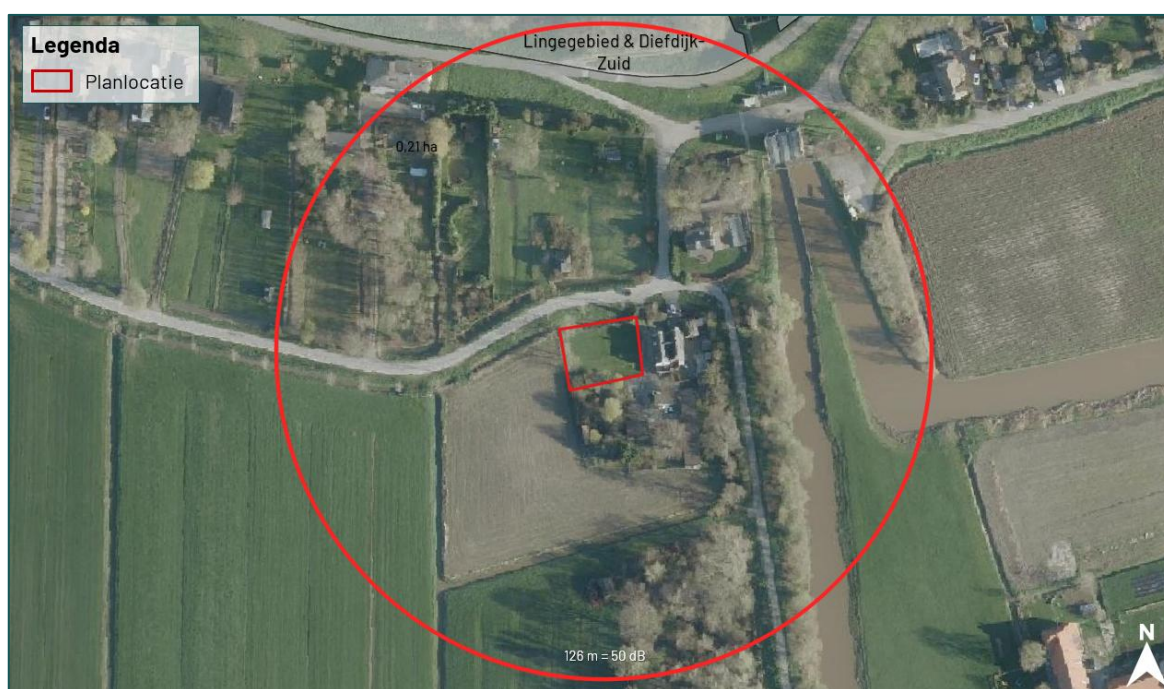
Figuur 5.9 Het piekgeluid van de bouwplaats is op 126m afgenomen tot 50 dB(A)
