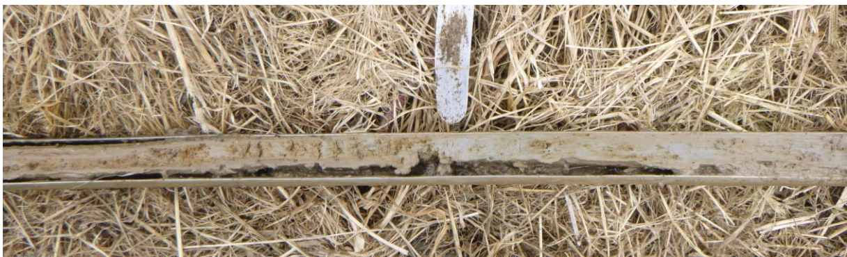
Figuur 19: De dunne zandsnoertjes (bij de punt van het mes) zoals deze in de boringen 3 en 6 zijn aangetroffen (in dit geval in boring 6).
