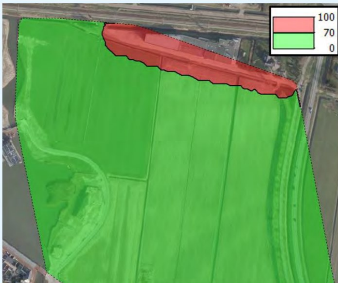
figuur 4: maximale geluidsniveau contour in de dagperiode (7.5 meter)
