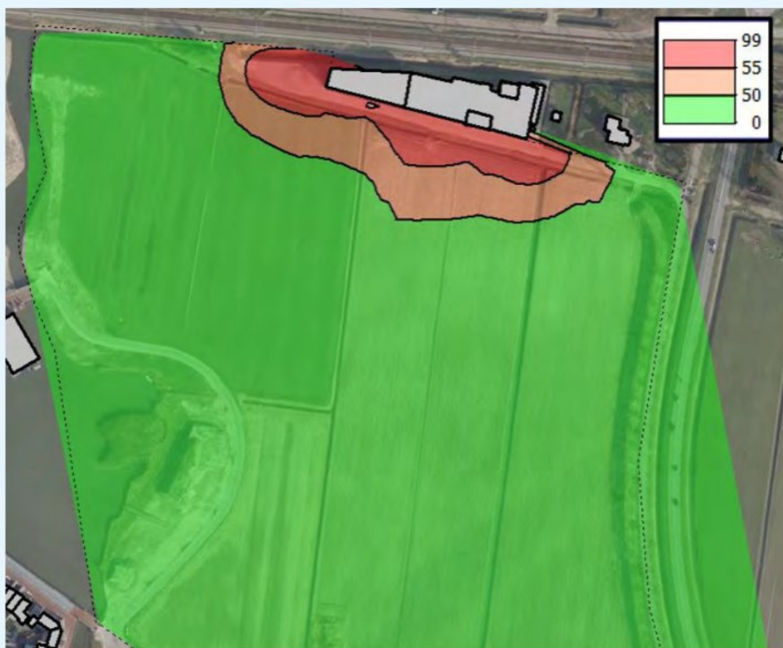
figuur 2: langtijdgemiddeld beoordelingsniveau contour (7.5 meter)
