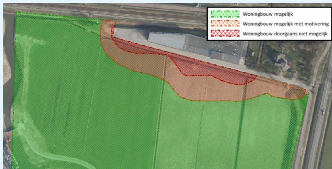
figuur 6: samenvatting contouren L_{Ar,LT} en L_{Amax}
