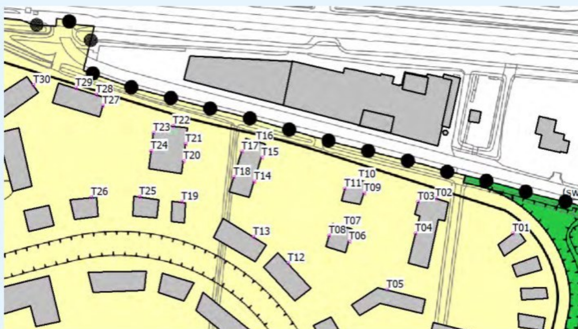
figuur 5: overzicht eerstelijns bebouwing en de ingevoerde toetspunten (T01 t/m T30).
