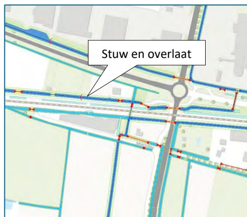
Figuur 9 Locatie stuw en overlaat
