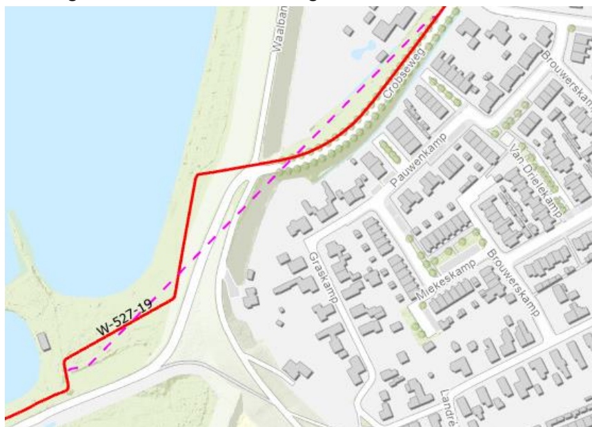
Figuur 1 In rood is de bestaande leiding weergegeven, paars is de beoogde verlegging
