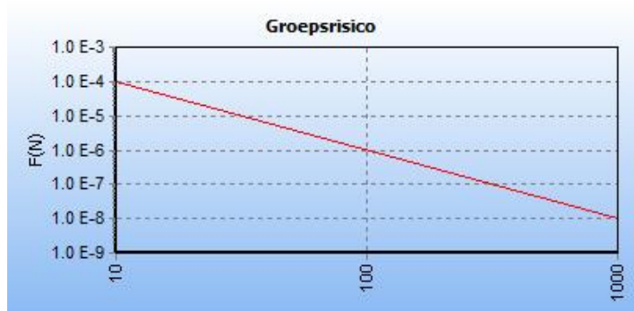
Figuur 15: De fN-curve voor deze kilometer leiding (leiding W-527-19 inclusief de verlegging).
