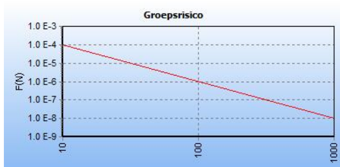
Figuur 12: De fN-curve voor deze kilometer leiding (leiding W-527-19 exclusief de verlegging).
