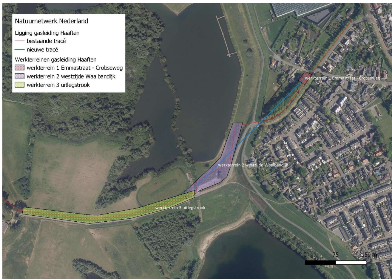
Figuur 2. Ligging werkterreinen verlegging W-527-19 Haaften. De werkzaamheden voor de nieuwe leiding vinden plaats op deze werkterreinen. Daarnaast wordt de oude leiding verwijderd. Het werkterrein hiervoor valt buitendijks samen met werkterrein 2. Binnendijks wordt de leiding uit de berm van de Crobseweg (rode lijn in zuidwestelijke richting vanaf werkterrein 1) weg verwijderd.
