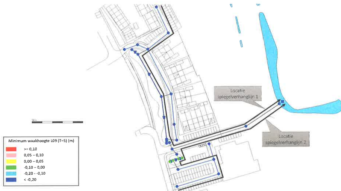
figuur 8 Minimum waakhogte in HWA stelsel tijdens ontwerpbui L09 (T=5)
