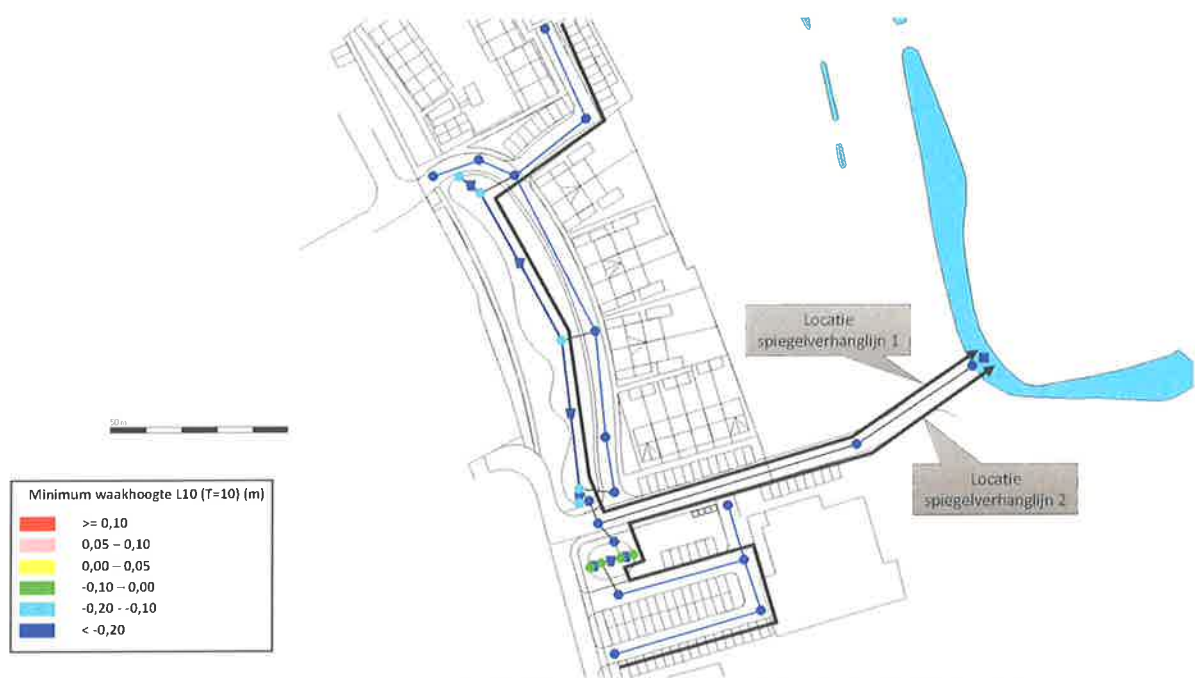
figuur 11 Minimum waakhogte in HWA stelsel tijdens ontwerpbui L10 (T=10)
