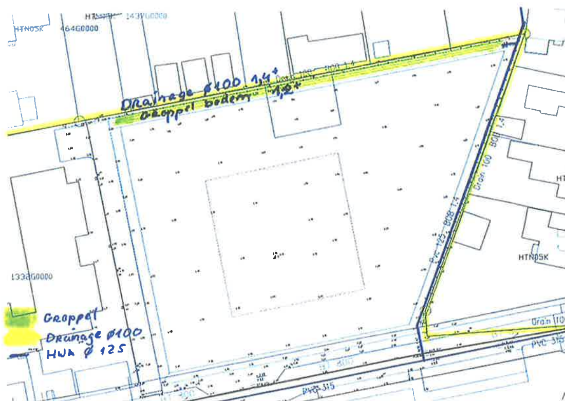
Figuur 14 Bestaande situatie drainage en greppel
