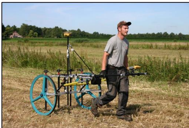
Afb. 1: Multi-sensorsysteem-4 non-realtime oppervlakedetectie
