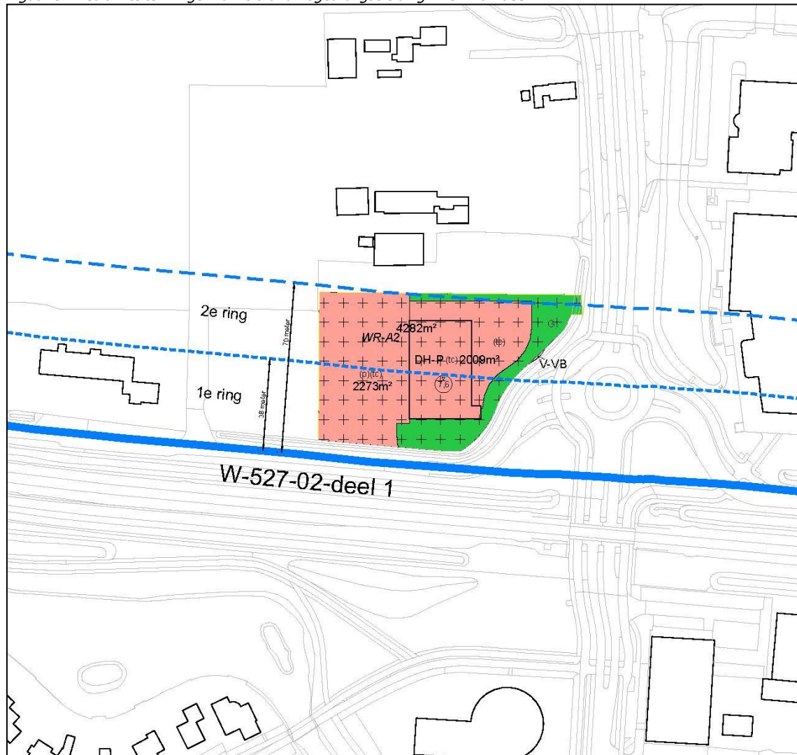
Figuur 5.1: Calamiteiten ringen fakkelbrand hogedrukgasleiding W-527-02-deel 1
