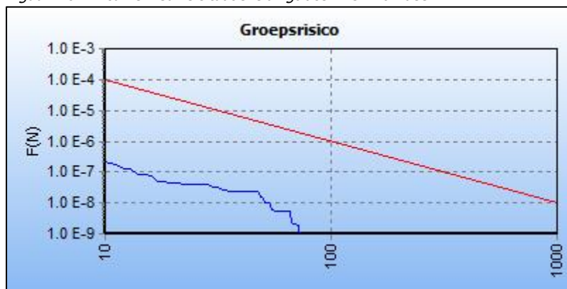
Figuur 4.8: fN-curve nieuwe situatie leidingtracé W-527-02-deel 1
