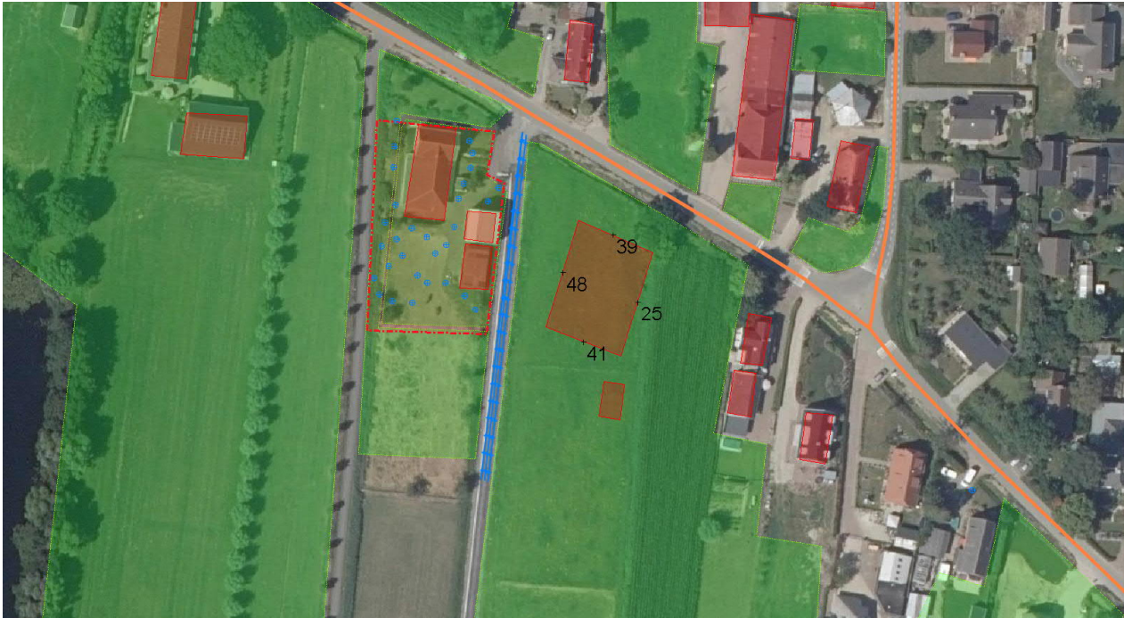
Figuur 6: geluidbelasting in dB(A), verkeer op de toegangsweg.
