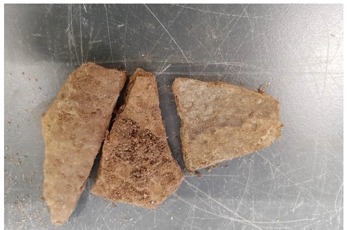
Foto 6: asbestverdacht materiaal GT9
