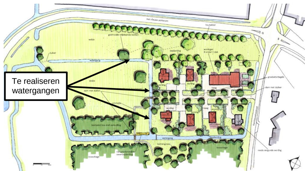
Afbeelding 45: Schets met de nieuw te realiseren watergangen
