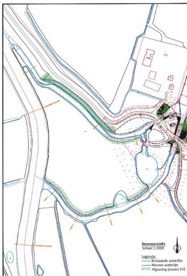
Figuur 2.16 De werkzaamheden aan de buitendijkse watergangen
