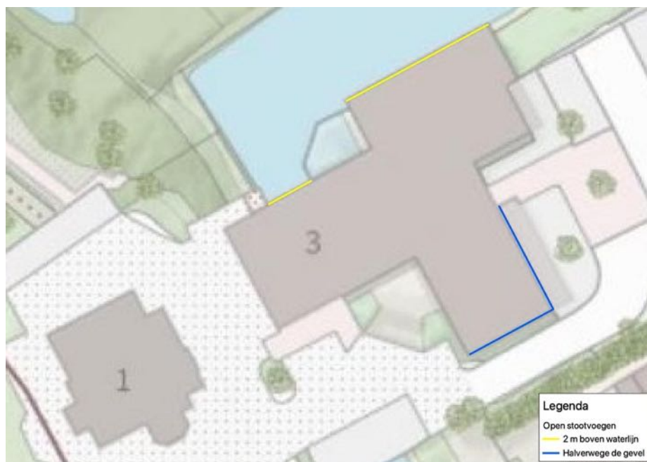
Figuur 10. Locaties van hogergeplaatste open stootvoegen.
