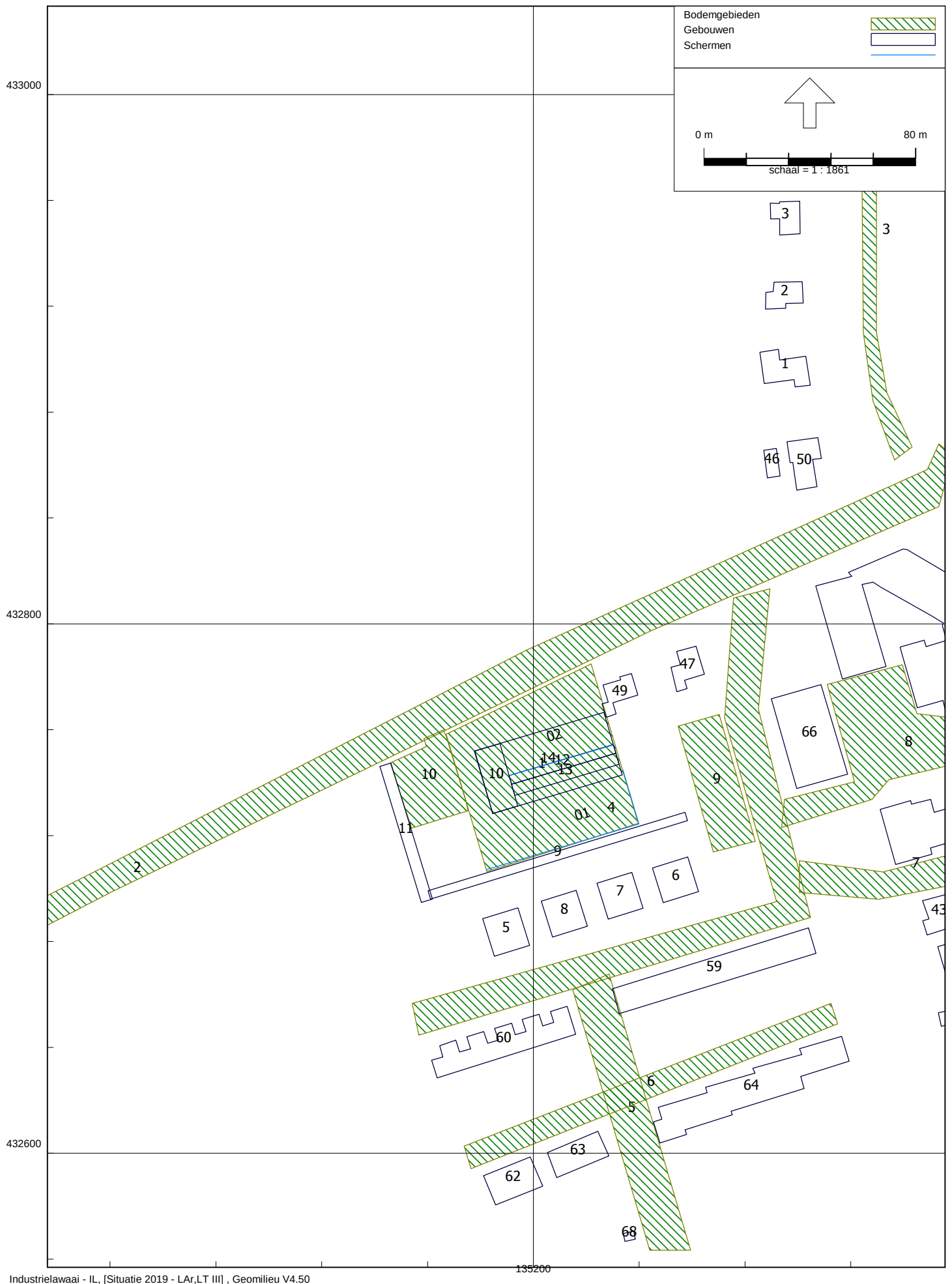
figuur 4a: Overzicht rekenmodel met positie objecten, schermen en bodemvlakken
