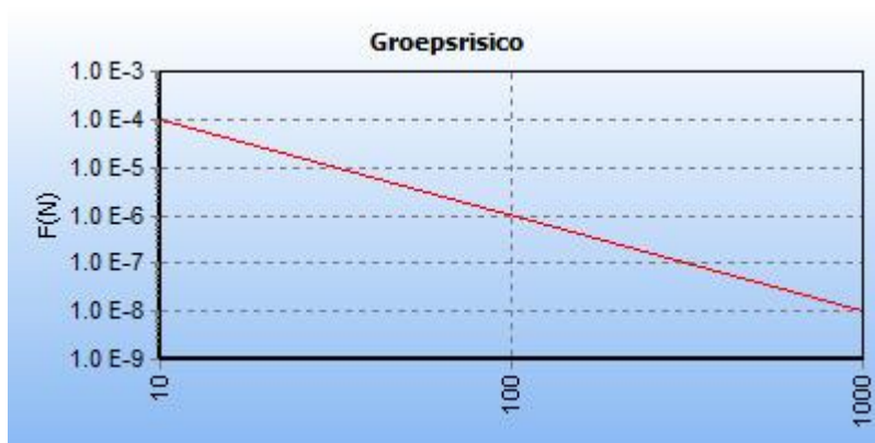
5.5 Figuur 5.5 FN curve voor 6370_leiding-Z-543-03-deel-1 van N.V. Nederlandse Gasunie voor de kilometer tussen stationing 0.00 en stationing 1000.00
