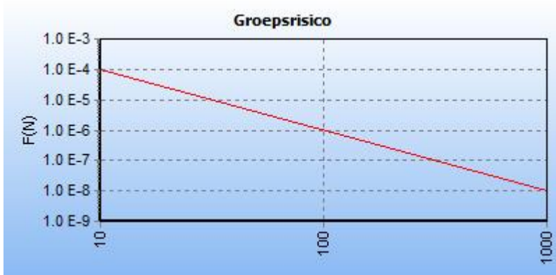
5.2 Figuur 5.2 FN curve voor 6370_leiding-W-543-02-deel-1 van N.V. Nederlandse Gasunie voor de kilometer tussen stationing 0.00 en stationing 0.00
