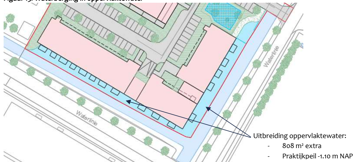
Figuur 13: Waterberging in oppervlaktewater
