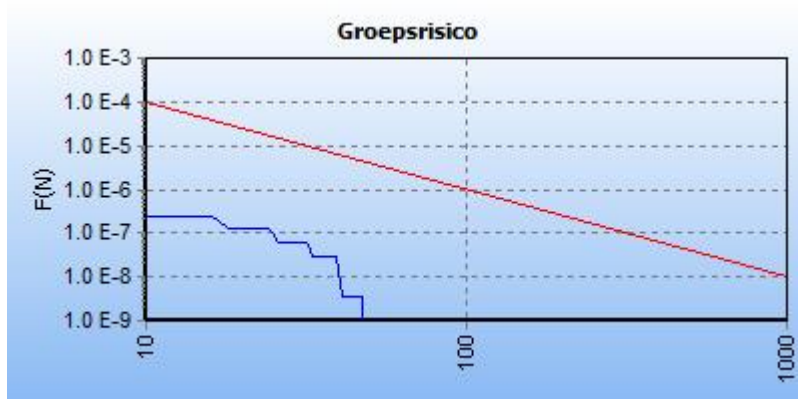
5.4 Figuur 5.4 FN curve voor 6679_leiding-Z-543-03-deel-1 van N.V. Nederlandse Gasunie voor de kilometer tussen stationing 850.00 en stationing 1850.00
