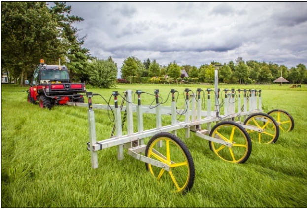
Figuur 3. Passieve non realtime oppervlakedetectie met het Vallon Multisondesysteem VXV16 en een staafdiagram waarop het maximale detectiebereik (m 2 - maaiveld) per kaliber.
