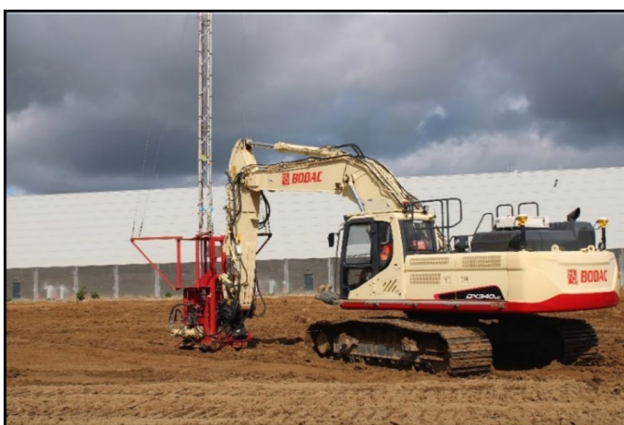
Figuur 8. Passieve realtime dieptedetectie m.b.v. MDE-drive en een voorbeeld prik raster voor vlak dekkende dieptedetectie waarbij het kleinste OO 1.000 lbs. bedraagt.
