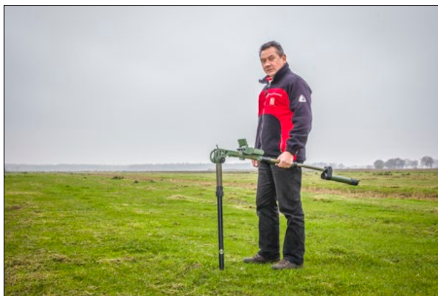
Figuur 5. Passieve realtime oppervlakedetectie met een Vallon VX1 Magnetometer en een staafdiagram waarop het maximale detectiebereik (m 2 - maaiveld) per kaliber.
