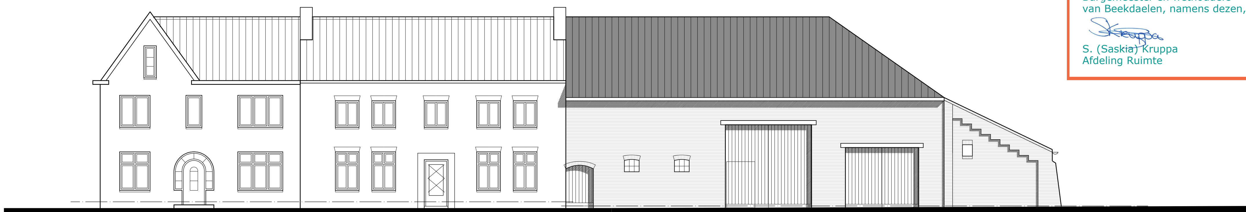
straatgevel bestaande toestand
