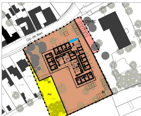
Figuur 11 Deel van de noordwestgevel dat, indien er geluidgevoelige ruimten worden gerealiseerd, uitgevoerd dient te worden als dove gevel
