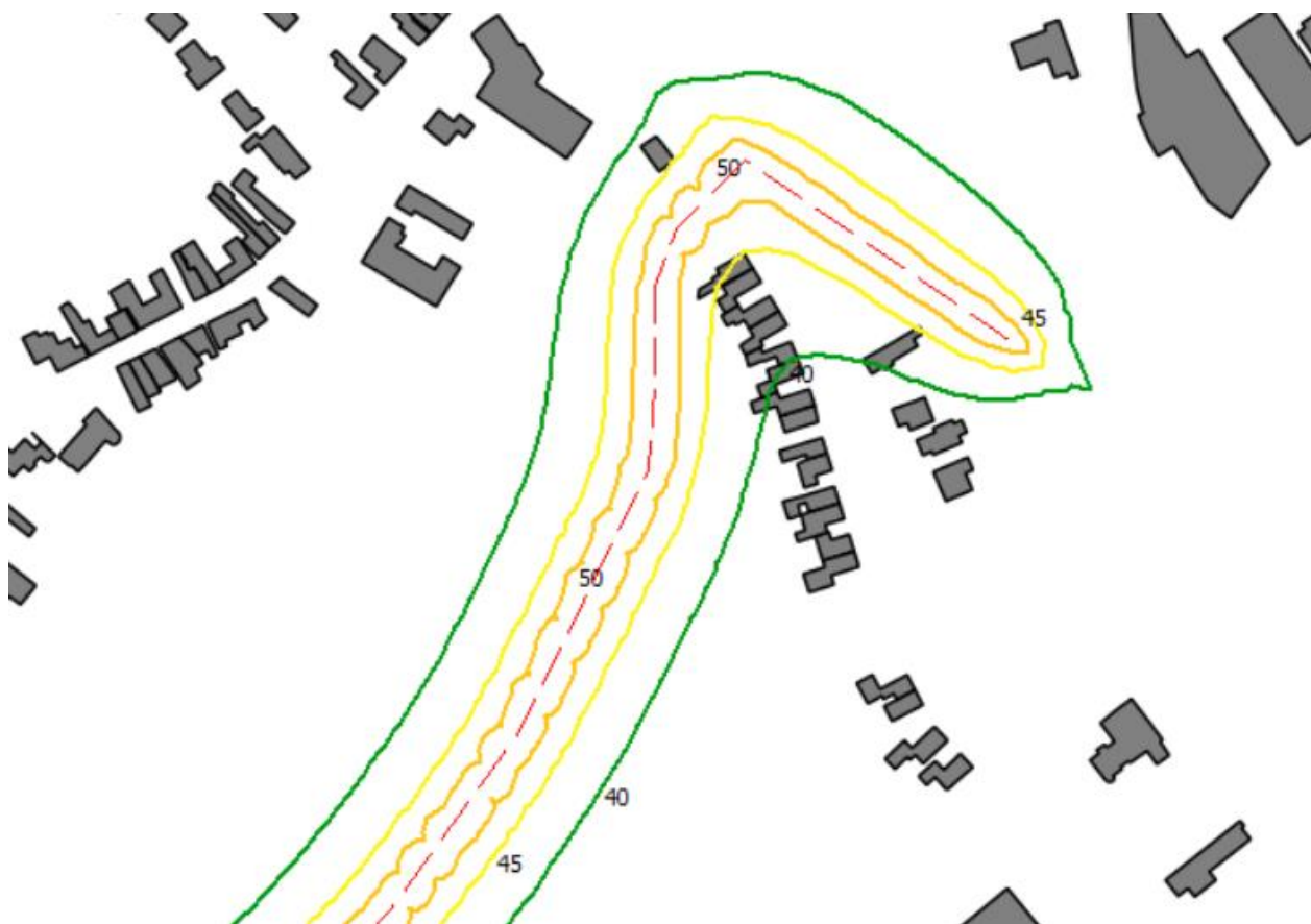
Figuur 2-3: equivalente geluidsniveaus in de dagperiode vanwege de verkeersaantrekkende werking in de bouwfase.
