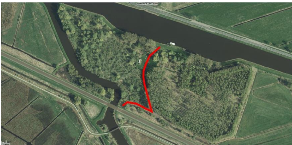
Figuur 7-1: Suggestie voor de aanleg van de kade in scenario 3, met de minste ecologische impact op het plangebied.
