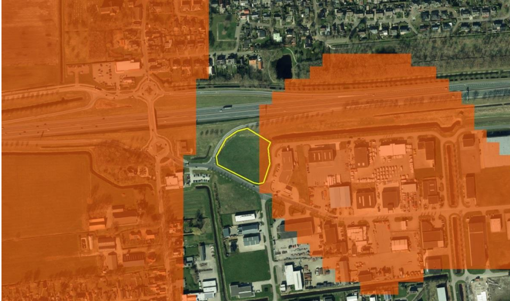
Op bovenstaand luchtfoto is in oranje het (mogelijk) voorkomen van slecht doorlatende bodemlagen weergegeven.
