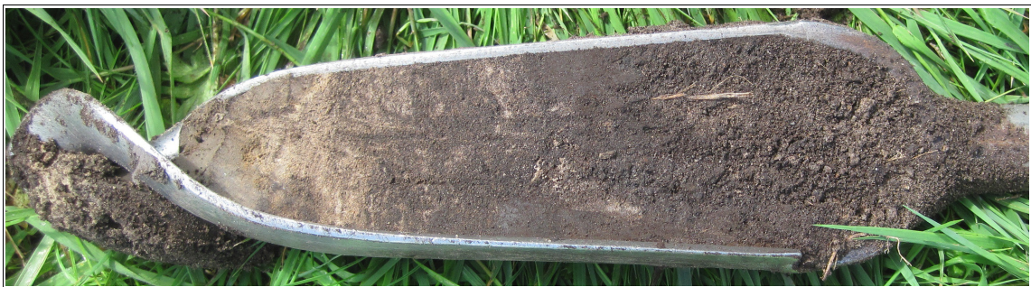
Figuur 11: Zuidbroek, Europaweg: boormonster boring 6 van 50 tot 60 centimeter diepte. Helemaal links in de punt van de boor zit leem. Rechts daarvan volgt beige dekzand, veen vermengd met zand en zandarm veen.
