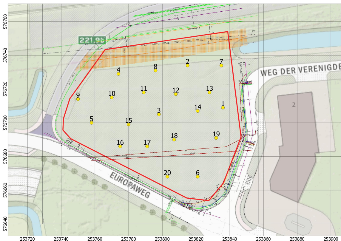
Figuur 10: Zuidbroek, Europaweg: boorpuntenkaart. Het plangebied is rood omlijnd. De twintig genummerde punten zijn de boorlocaties. Door het noorden van het terrein loopt een leiding van de Gasunie die met een oranje lijn wordt weergegeven. Door het zuiden lopen twee elektriciteitsleidingen van Enexis.
