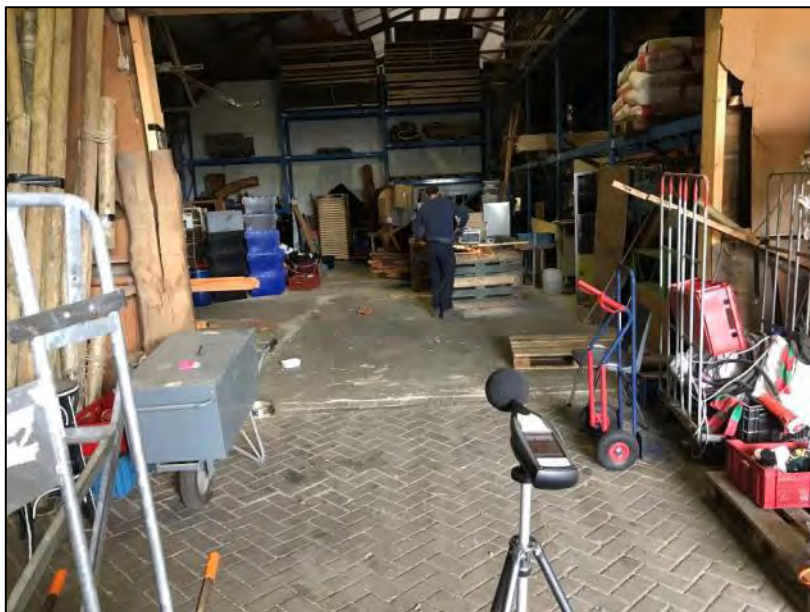
Figuur 15: Geluidsmetingen tijdens het werken met de slijptol
