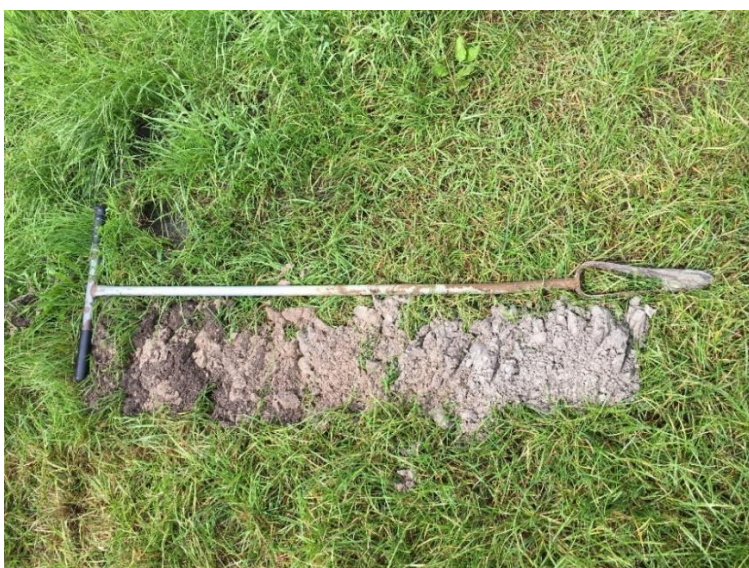
Figuur 2.6 Grondboring in het veld. Tot een diepte van 1,5 meter bestaat de bodem uit fijn zand en is er geen grondwater waargenomen (25 juni 2018).
