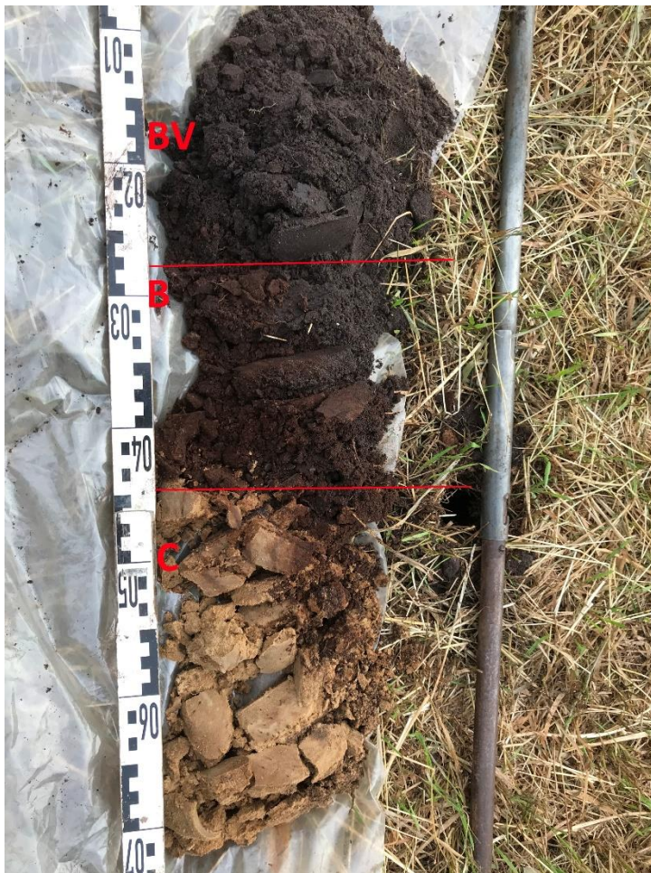
Afbeelding 12. Boring 5, met van onder naar boven de bouwvoor (BV), de B-horizont (B) en C-horizont (C).
