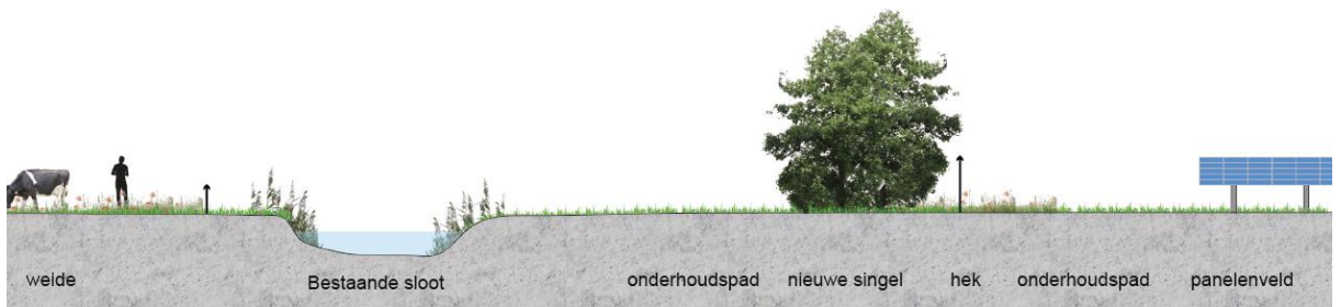
Figuur 6: Dwarsprofiel westkant (de zwarte lijn betreft het huidige maaiveld)
