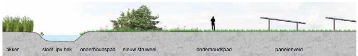
Figuur 5: Dwarsprofiel noordkant
