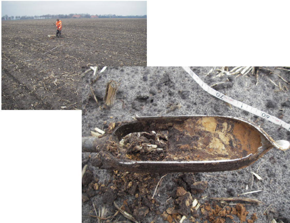
Figuur 7: Vlagtwedde, Bourtangerweg 21a: foto's tijdens het veldwerk. Onder: de overgang van de verstoorde laag naar het natuurlijke zand (C-horizont); boven: foto van het veldwerk. De foto is in het oosten van locatie 2 genomen (richting het westen).
