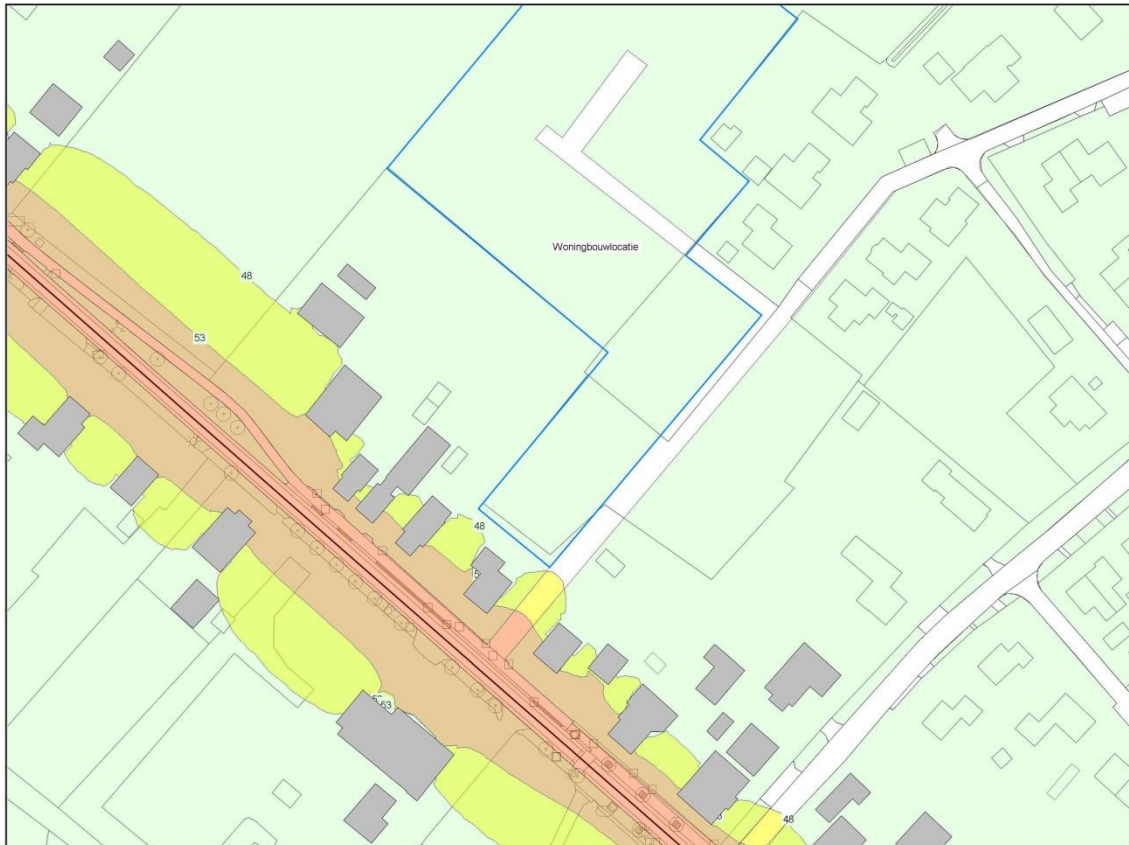
Figuur 2.1 48 en 53 dB geluidsbelastingcontouren 4,5 m hoogte
